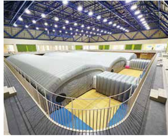
多目的体育館内に整備されたエアテント型放射線防護施設
