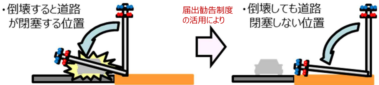
【道路の閉塞を防止する仕組み（イメージ）】
