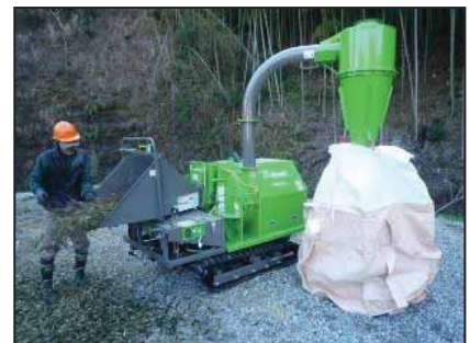
▲樹木粉碎機での作業の様子
