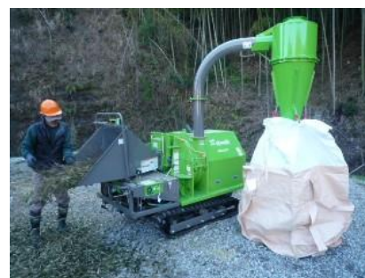
▲樹木粉砕機での作業の様子
