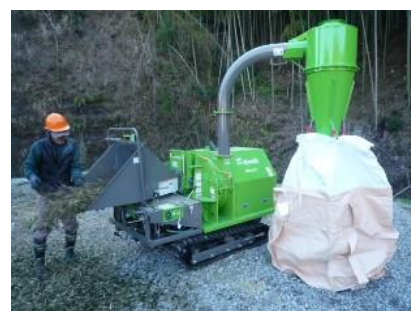
▲樹木粉碎機での作業の様子
