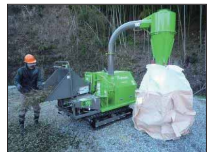
▲樹木粉碎機での作業の様子
