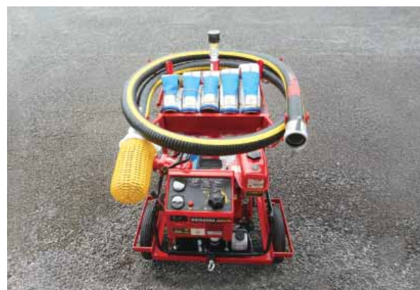
整備された可搬ポンプなどの消防資機材
