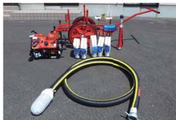
整備された可搬ポンプや吸管、消防ホースなどの資機材
