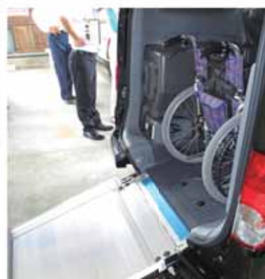
車いすも乗れるスロープ
