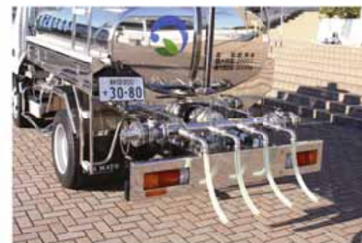
後方4箇所からの給水が可能です
