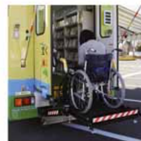
後部扉下の電動リフトで車いす利用者も安全に乗車
