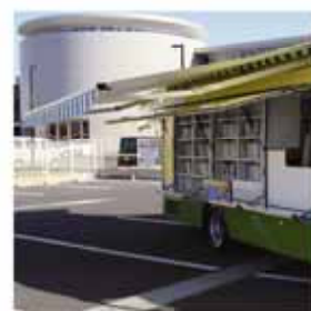
雨や日差しを防止する自動巻き取り式のテントを装備
