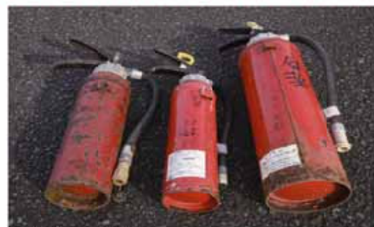
↑老朽化した消火器
